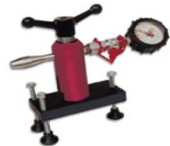
Sistema de Anclajes estándar. Para medir la resistencia de anclaje
