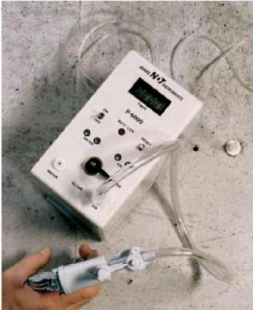
Prueba de Permeabilidad de Agua
