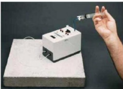
Prueba de Permeabilidad de Aire
