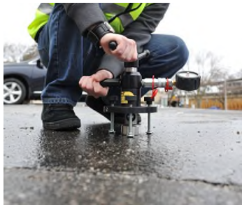
James Bond Test™ MK III en uso en el asfalto
