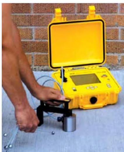
Sistema VuCon siendo usado para medir el espesor de una losa
