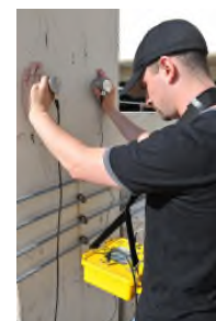
Transductores utilizados en modo indirecto
