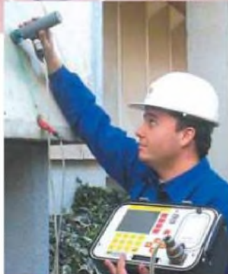
Medición de la resistividad con el sensor "B"
