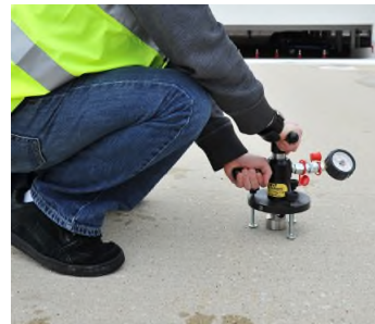
James Bond Test™ MK III en uso en el hormigón
