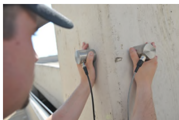
Transductores utilizados en modo semi-directo
