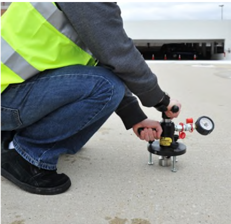
Ensayo en horizontal en hormigón
