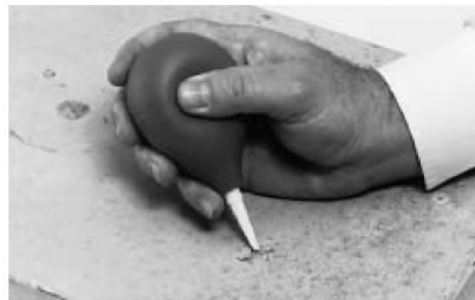
Limpieza Soplador de aire limpiando un agujero de clavo antes de medirlo
